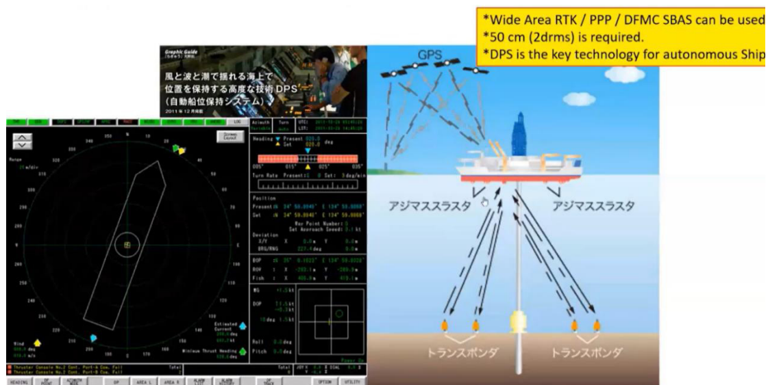
Рис.9.4. Позиціонування бурових платформ
