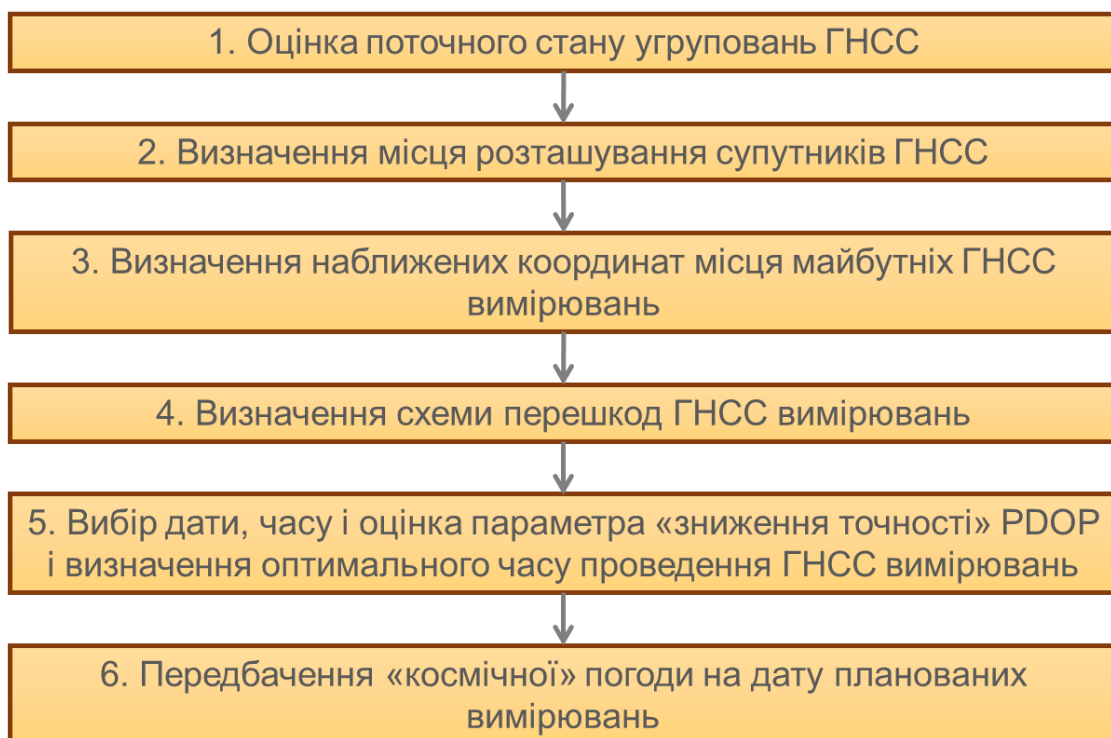
Рис. 7.1. Алгоритм визначення місця розташування станції ГНСС
