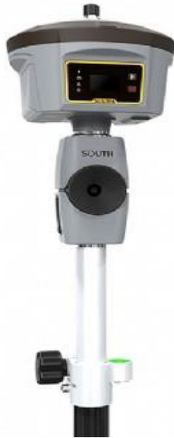
Рис. 4.18. ГНСС приймач INSIGHT V1
